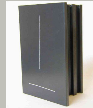
Bild: Prüfbleche nach Haftungstests und Kochtest
