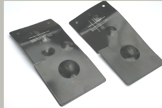
Bild: Prüfbleche nach Haftungstests und Kochtest
